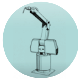
溶接ロボット
