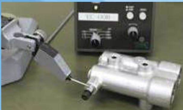
基準面からのねじ穴高さ測定（インジケータ測定）
