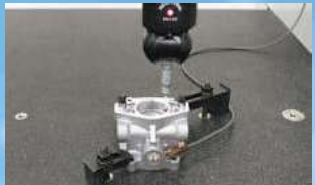
基準穴からのねじ穴距離や位置度の測定（三次元測定）
