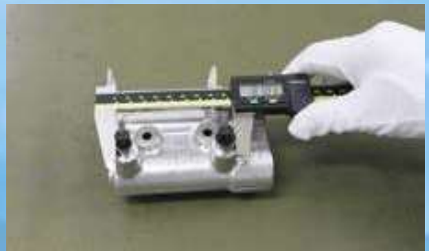
複数のねじ穴ピッチ距離の測定（ノギス測定）
