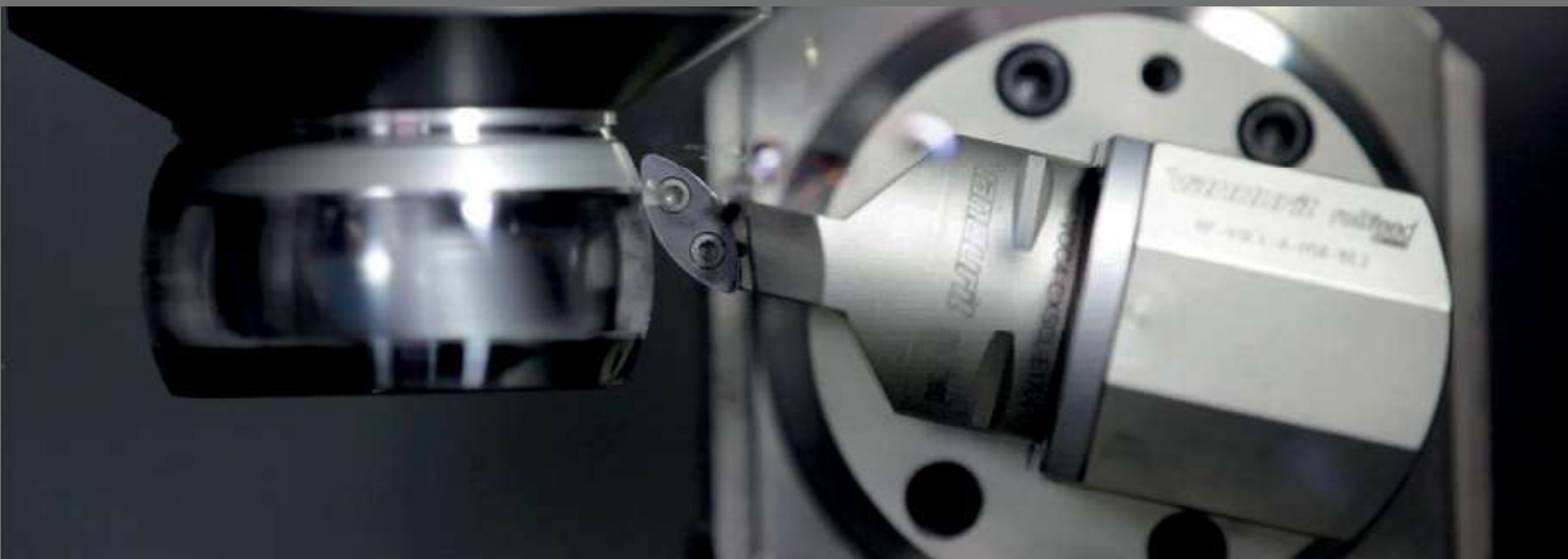
Kugelkäfig (Hartdrehen) Feinschlichten | ball cage (hart part turning) fine-finishing
